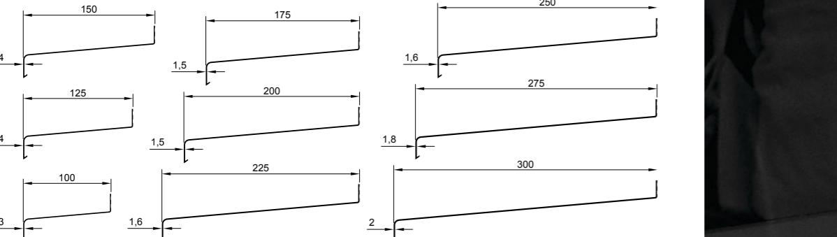
Okapnice su širine od 100 mm do 300 mm, dužine 6 m i dostupne u beloj RAL9016, braon RAL8014, eloksiranoj E0 i sirovoj varijanti. Sirove okapnice mogu se plastificirati po želji.
