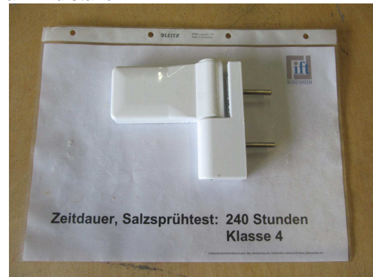
Bild 4 Ansicht Probekörper nach der Korrosionsprüfung
